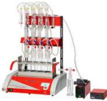
**CN 4-IR** Инфракрасная система быстрого распада с регулируемой мощностью и 25 свободно настраиваемыми программами для определения цианидов в макс. 4 Образца, включая. Мембранный вакуумный насос и газовый промывочный баллон
