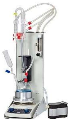
**KCM 1-N** Компактный аппарат для разложения и разделения с магнитной мешалкой, колба объемом 500 мл, для определения общего количества цианида, включая количество цианида в смеси. Мембранный вакуумный насос
