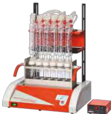
VFZ 6 аппарат для обратной дистилляции для определения количества омыления, 6 мест отбора проб за раз.
