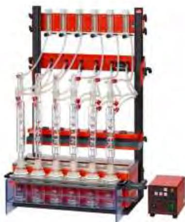
VAE 6 предварительно протестируйте омыляющий аппарат для определения содержания витаминов А и Е в блоке с интегратором. Магнитная мешалка на 6 мест с емкостями по 250 мл.
